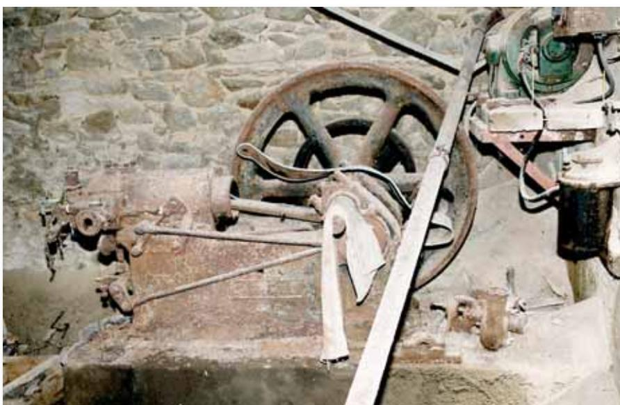
brasseur à palettes conçu comme une vis sans fin. L'ensemble mécanique était activé par un jeu de poulies et de courroies dont l'arbre principal était mu par un moteur. Cette machinerie composite comporte des éléments de menuiserie artisanale (bâtis, bacs à
